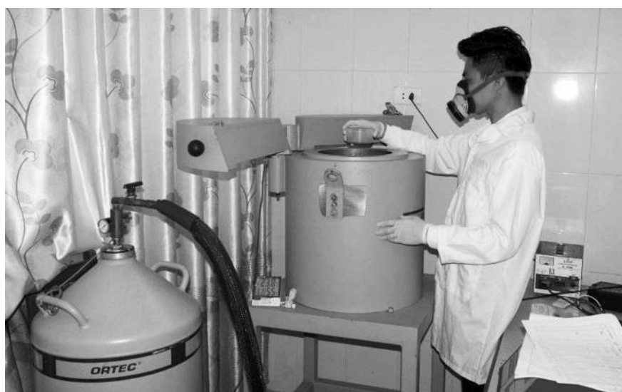
Phân tích các nhân phóng xạ tự nhiên trên mẫu môi trường bằng thiết bị ORTEC-GEM 30
